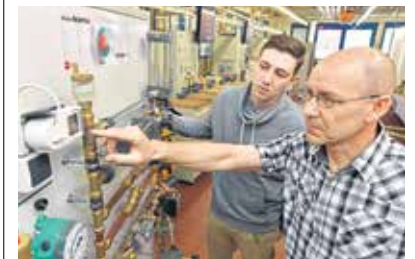
Hinter Wilo-Brain versteckt sich ein System, mit dem Funktionsweise und Bauteile von Heizungsanlagen sichtbar werden.
